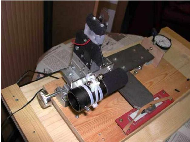
Das Gerät ist nach Texereau gebaut. Die Längs-Bewegung wird über einer M6 Schraube gesteuert. Man kann die Schnittweite sowohl anhand der Skala auf dem Drehknopf (Links im Bild) als auch auf der Messuhr ablesen. Die seitliche Bewegung wird durch das Einschwenken des Kreuzes mit Hilfe einer M1,5 Schraube durchgeführt (Rechts unten im Bild).
